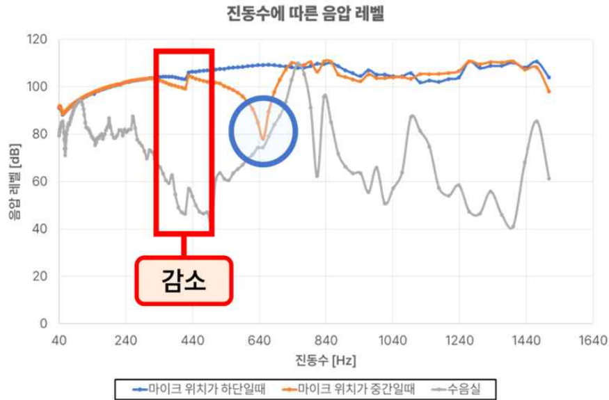
그림 16) 마이크의 위치에 따른 진동수에 대한 음압 레벨 그래프
