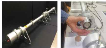
그림 6) 연구 과정에서 사용한 투과 손실 측정장치
