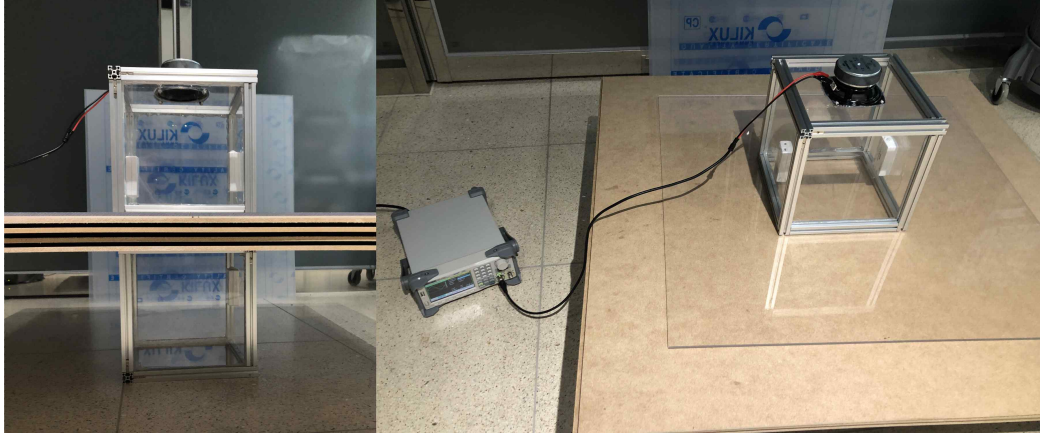
그림 34) 아크릴과 MDF 혼합 재질에서의 투과 손실 측정
