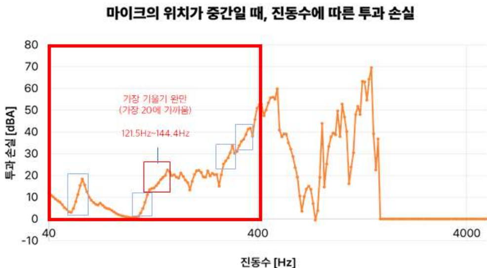
그림 17) 진동수에 따른 투과 손실 그래프를 통해 질량 법칙 적용 구역 예측
