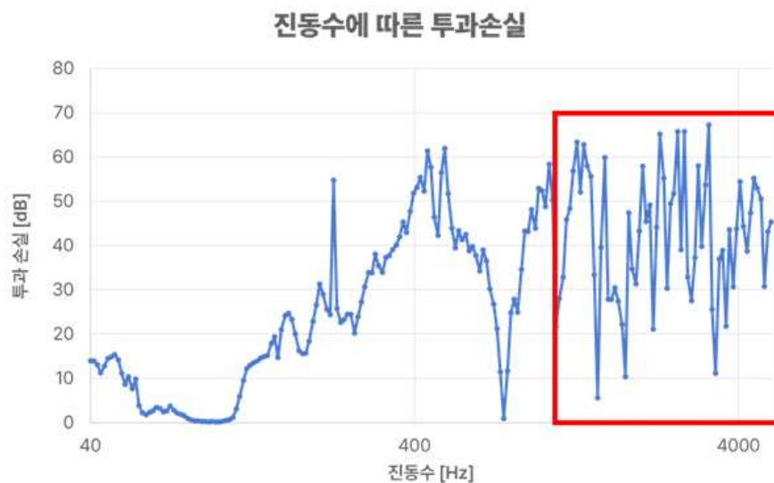
그림 15) 진동수에 따른 투과 손실 그래프 (40Hz~5000Hz)
